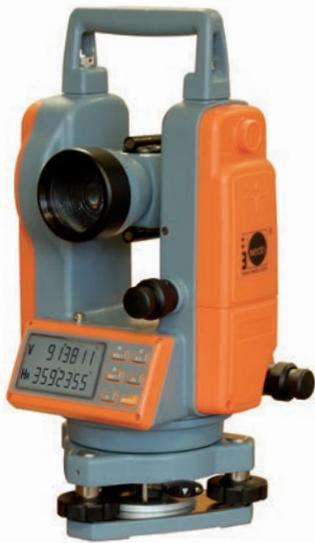
Robuster Bautheodolit mit Digitalanzeige und automatischem Vertikalkompensator. Präzision, Zuverlässigkeit und die einfache, intuitive Bedienbarkeit zeichnen den elektronischen Bautheodolit Nedo ET-5 aus.
